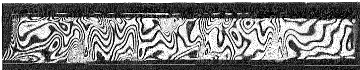
Abb. 26 Instationäre Vorgänge in der gesamten Flüssigkeit; Ra_{W1} = 170000 ; B = 0.14 : Interferogramm horizontaler Strahlentrennung ( e = 0,3 mm)
