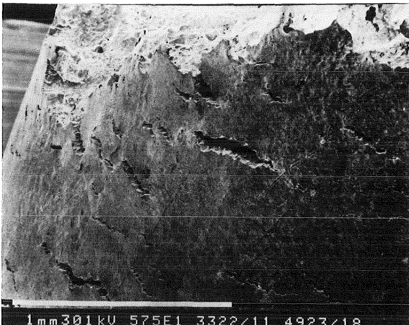
Bild 9.51: Probenman- tel mit Anrissen: \text{Li}_{\text{Li},0,2} ; 570:1
