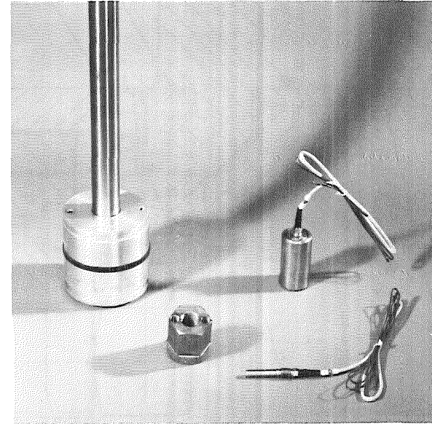
Abb. A1.8- Ansicht des Kolbens aus Hartaluminium und der Sprengkapseln.
