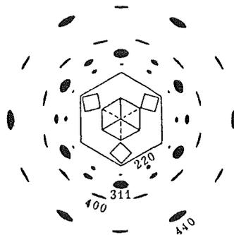
Abb. 59: Schematische Darstellung des Elektronenbeugungsdiagrammes von  $\gamma$ - $\text{Al}_2\text{O}_3$ , es treten zwei Arten der Orientierungsbeziehung zum ursprünglichen Kaolinit auf (aus Tsuzuki 1961).
