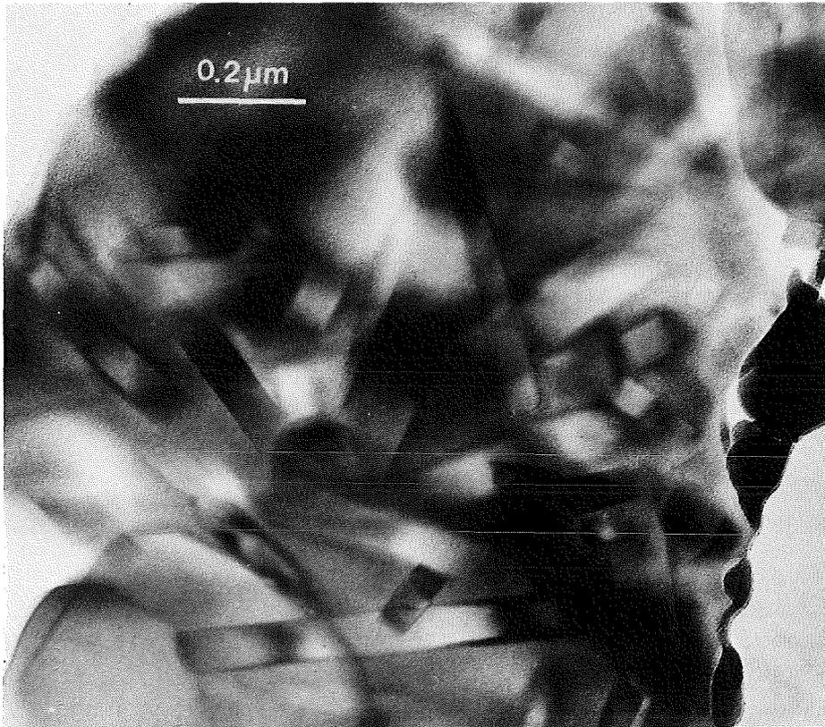
Abb. 40: Probe KAB 78-TRU-FS, 10' 1350°C. HF-Aufnahme, Ausschnitt des submikroskopischen Gefüges, Mullitnadeln liegen eingebettet in Glasphase.
