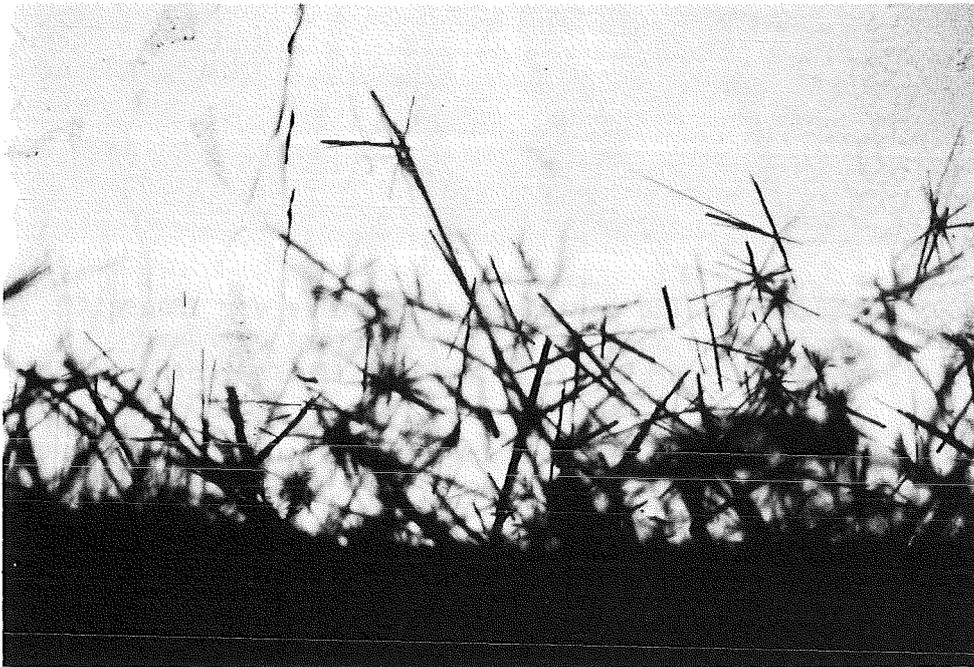
Abb. E64      *Die "Phase X" kristallisiert zunächst am Tiegelboden der 1000°C-Proben, bildet dann aber auch innerhalb der Glasschmelze radialstrahlige Aggregate. (s. auch Abb. E18) (ER 2161 / GP 98/12.2 64/1000) (Durchlicht) |——1mm——|*
