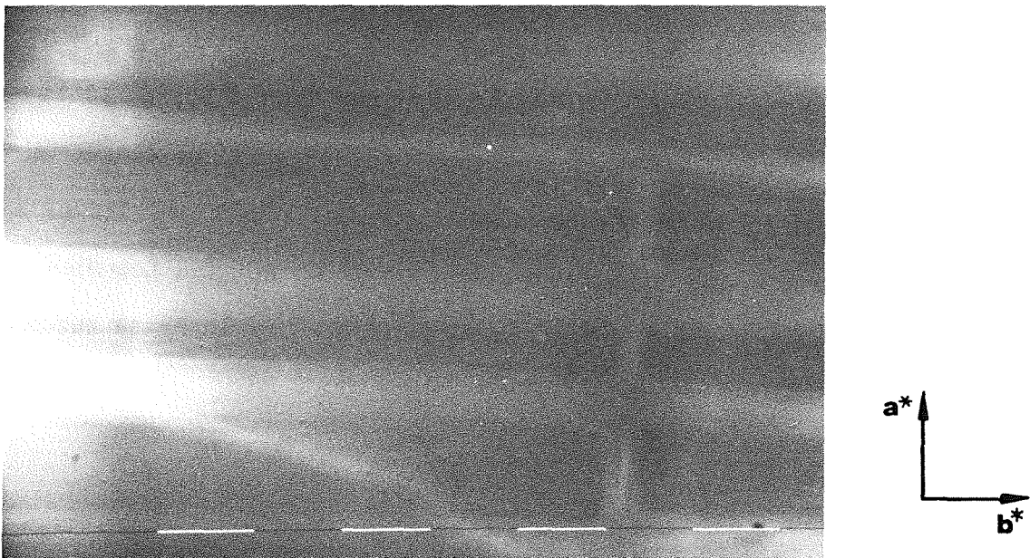
Abb. 53 Rastertransmissionselektronenmikroskopische Hellfeld-Aufnahme (Probe mit 35mol% K-Feldspat, entmischt bei 600^{\circ}\text{C} , 4d) (1 Teilstrich \approx 0,5\mu\text{m} ).
