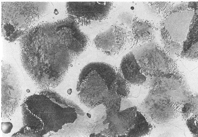
Abb.12.13: Orplid hart (Wärmebehandlung: 1 Stunde bei 923 K ; geätzt)
