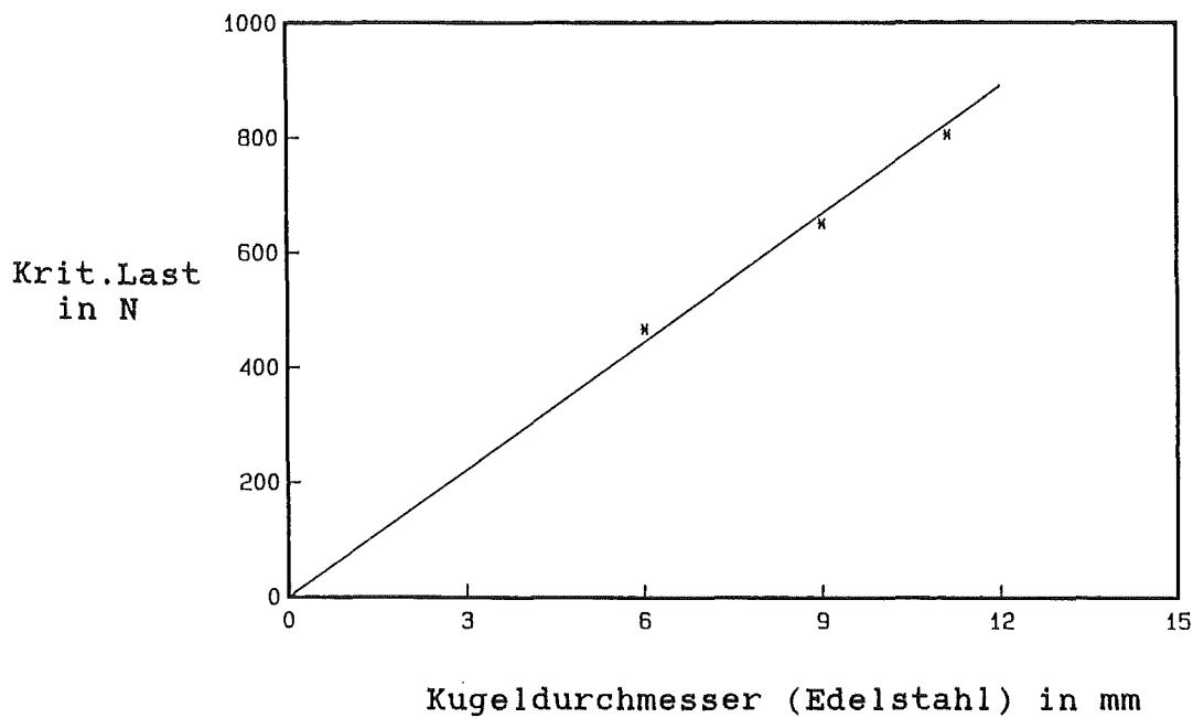
Abb.12.70: Kritische Last in Abhängigkeit vom Kugeldurchmesser (TiO 2 -Edelstahl)
