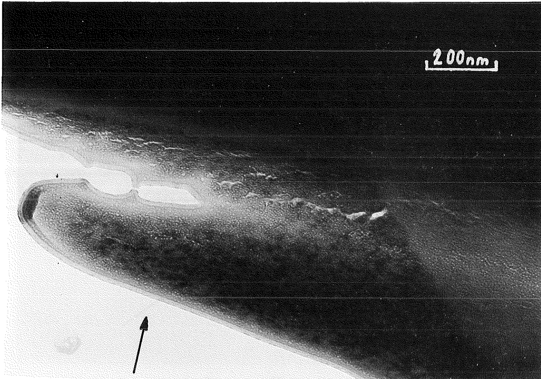
Abb. 6.20 \text{Al}_2\text{O}_3 nach Implantation von 3 \cdot 10^{22} Ionen / \text{m}^2 bei 200^\circ \text{C} ( 100.000-fach )
