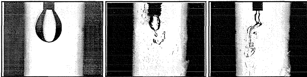
Abbildung 4.9: Lösungen mit a) wenig 1-Butanol ( x=0.015 ), b) viel 1-Butanol ( x=0.47 ) und c) reines 1-Butanol in überkritischer Kohlendioxidumgebung bei p=25 MPa und T=333 K.
