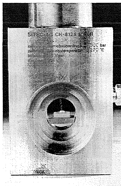
Abbildung 3.6: Autoklav der Firma SITEC mit Teflonprobe und Tropfen.
