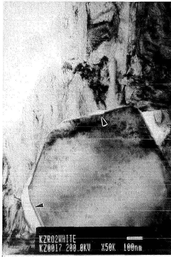
Abb. 5.2.8: Risse zwischen Spinell-Partikeln und der Matrix
