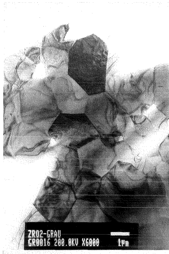
Abb. 5.2.9: TEM-Aufnahme des Gefüges von Ce-TZP
