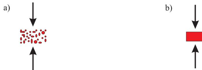
**Abbildung 4.8:** Schematische Darstellung einer uniaxialen Druckkomponente im Probenraum. Da bei einer pulverisierten Probe Kristallite in  $a$ -,  $b$ - und  $c$ -Achsenrichtung komprimiert werden (Teilbild a)) sind hier unerwünschte uniaxiale Druckkomponenten leichter zu erkennen als bei einem Einkristall (Teilbild b)). Einzelheiten im Text.
