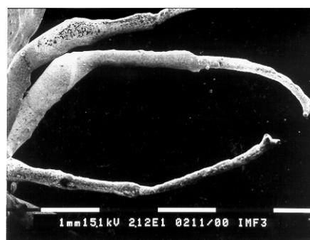
**Abb. 7.3:** Gegossene Fliege (TS7) aus der Au-Ag-Cu-Legierung, hergestellt im Vakuum-Druckguss und einzelntes Mikroturbinegehäuse (TS2) aus der Ad-Pd-Cu-Legierung (oben). Die unteren Bilder zeigen das Bein einer echten Fliege (links) und der gegossenen Fliege (rechts) im Rasterelektronenmikroskop. Zur Formfüllung ist eine Fließlänge von einigen Millimetern erforderlich.
