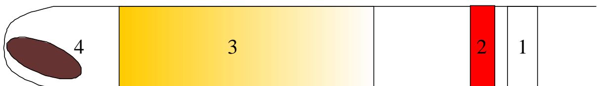
Abb. 3.4.3.1.: Schematische Darstellung des Glasrohrs mit verschiedenen Abscheidungen nach einem Sinterexperiment bei 800 °C, 7 Tage, frischer Abbrand mit 10 Gew. % NaCl, Bereiche 1 - 4 siehe Text
