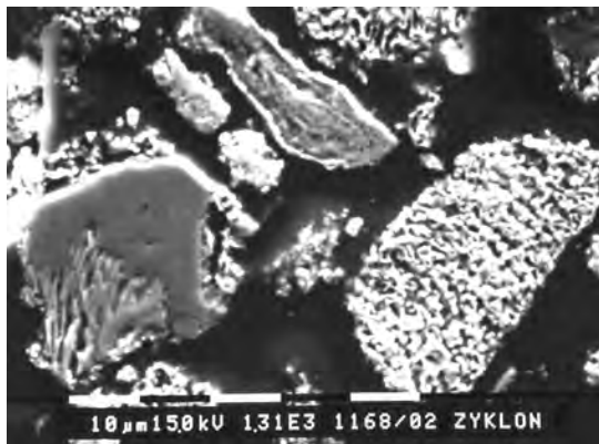
Abb. 3.2.2.1.: Typisches Gefüge des frischen Abbrandmaterials aus der 1. Kammer des Zyklons in einem Anschliff im REM (BSE), sehr helle Partikel: Hämatit, A: graues, glattes Korn: Feldspat (Na,Ca), B: hellgrau, verästelt: Mg-Fe-Aluminiumsilikat (evtl. Klinochlor)
