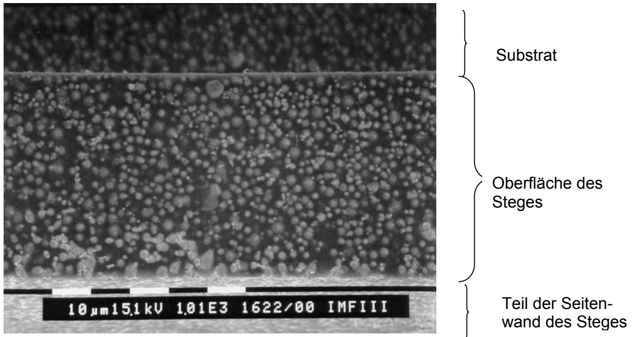
Abbildung 5-10: Stegstruktur eines Grünlings, die die Pulverpartikel in der Binder matrix zeigt (Catamold F)
