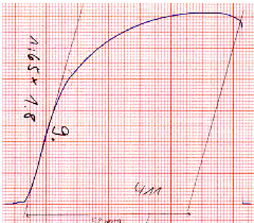
Abbildung 5-59: Diagramm eines durchgeführten Mikrozugversuches an einer gesinterten Carbonyleisen-Probe
