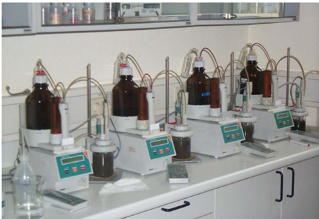
**Figure 4.7:** Automatic titration unit (Metrohm Titrino 719 S)
