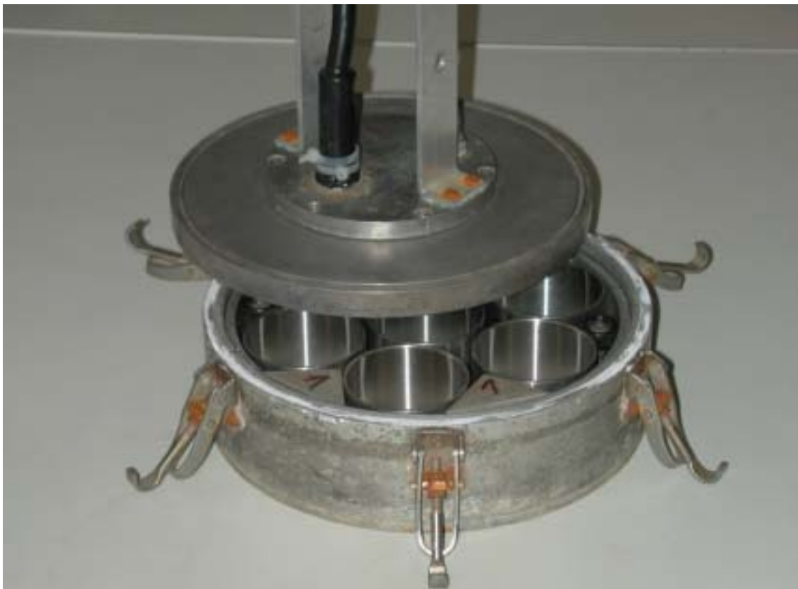
Abbildung 2-10: Die Meßküvette des weiterentwickelten BaPS-Systems einschließlich Stechzylindern, Tablett und Dreieckstücken zur Volumenreduzierung.
