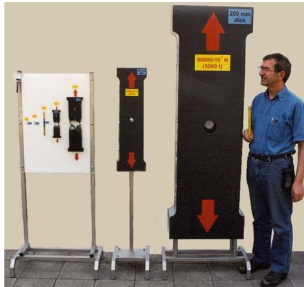
Abbildung 1.1: Flache Zugproben aus Stahl, die im Rahmen des LISSAC-Projektes zur Ermittlung des Größeneffektes quasistatisch bei Raumtemperatur getestet wurden (aus KRIEG ET AL. [46]).
