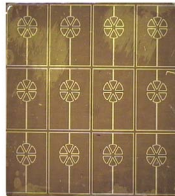
Abbildung 4.10: Parallelfertigung einer mikrostrukturierten NiTiPd-Dünnschicht.
