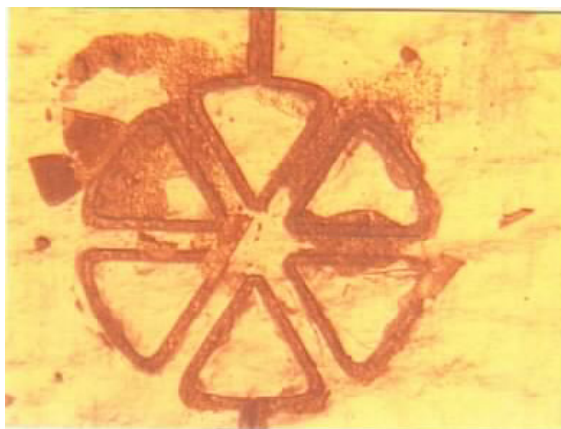
Abbildung 4.1: Wegen der Instabilität der Lackschicht beschädigte Mikrostruktur.
