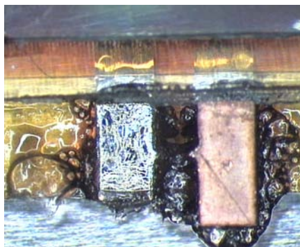
Abbildung 4.21: Beschädigung der Kunststoffbauteile durch anisotropes Kleben.
