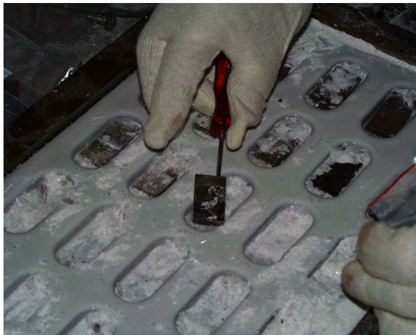
Abb. 3.6: Entnahme der Glasproben nach 10,2 Jahren Lagerung in kompaktierem Salz
