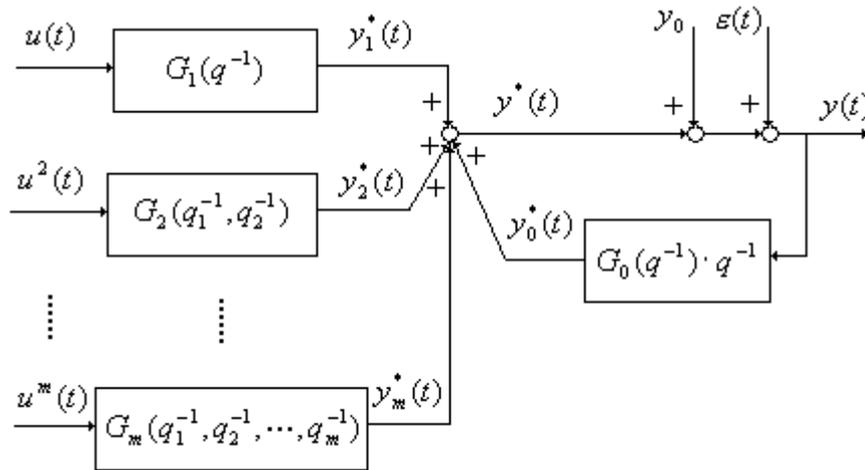
Fig. 6.1 Parametric Volterra-series model
