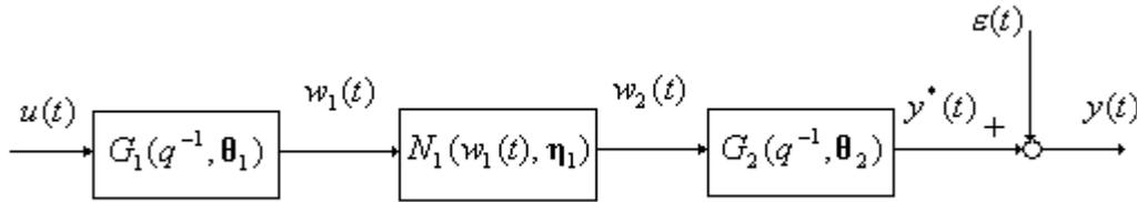
Fig. 5.1 Wiener-Hammerstein system (LNL)
