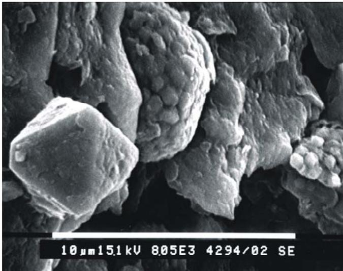
Abbildung B 2b: Typische Framboide aus dem Konzentrat der Probe SABS\_1 (SE-Bild, REM).
