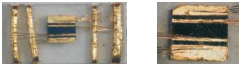
Abbildung 4.11: Ansicht einer mit „Wire-Bonding“ kontaktierten Probe. Im linken Bild eine mögliche Realisierung elektrischer Kontakte mit einer Saphirscheibe ( $4 \cdot 8 \text{mm}^2$ ) und Goldstegen, an denen die Zuleitungsdrähte der Messgeräte befestigt werden. Rechts die Detailansicht der Probe mit den äußeren Stromkontakten und den inneren Spannungsabgriffen. Hier sind alle Kontakte vierfach ausgeführt.
