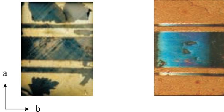
Abbildung 4.8: Ansicht der ab-Fläche ( $1.6 \cdot 1.1 \text{ mm}^2$ ) eines Kristalls. Links aufgesputterte Kontaktschichten ohne Temperaturbehandlung nach einem kurzen Ultraschallbad. Im rechten Bild Kontaktflächen (Dicke ca.  $1 \mu\text{m}$ ), hergestellt nach dem optimierten Verfahren, ebenfalls nach Reinigung im Ultraschallbad.
