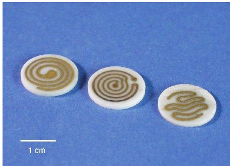
**Abb. 4.4-7: Flächenheizelemente aus  $\text{Al}_2\text{O}_3/\text{TiN}$  (50 vol% TiN).**
