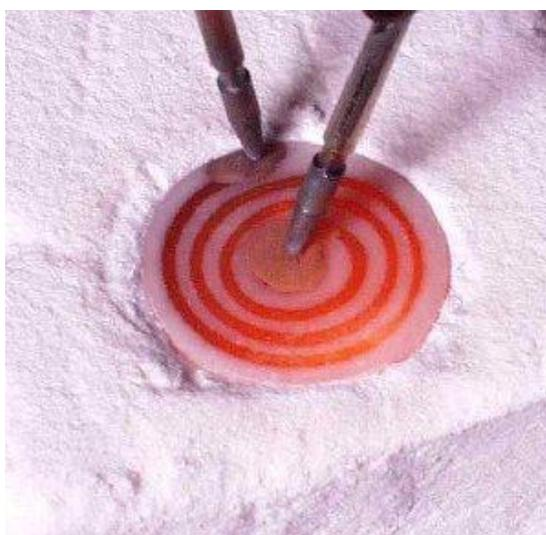
**Abb. 4.4-8: Flächenheizer im Betrieb an Luft mit  $\text{Al}_2\text{O}_3$ -Schutzschicht (Kontaktpunkte mit Aktivlot versehen) und Messspitzen zur Kontaktierung.**
