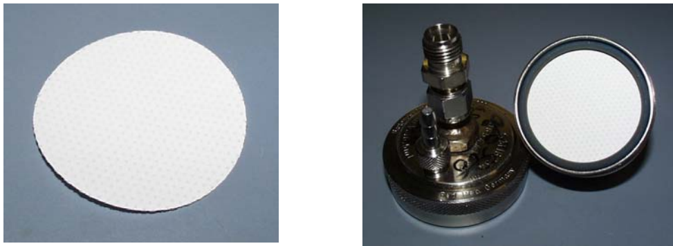
Abb. 6.3 Planfilter (links) und Filtergehäuse (rechts) für gravimetrische Messungen
