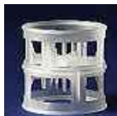
Abb. 5.2: Füllkörper in Füllkörperkolonne, Vereinigte Füllkörper Fabrik GmbH + Co.; Pall@Ring; Größe 15 mm; Gewicht 80 \text{ kg/m}^3 ; spezifische Oberfläche 350 \text{ m}^2/\text{m}^3 ; freies Volumen 91% [5-1].
