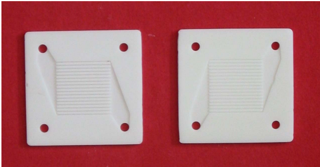
Abb. 5.94: Gesinterte Kanalplatten vor dem Fügen ins Gesamtsystem.
