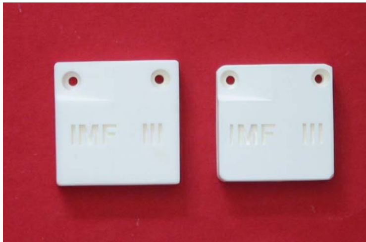
Abb. 5.85: Schnelle Realisierung von Designänderungen am gesinterten Deckel.
