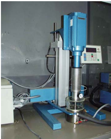
Abb. 4.4: Labordissolver Dispermat CA 40-C der Firma VMA Getzmann, Dissolvrührer und Fließschema während der Dispergierung.
