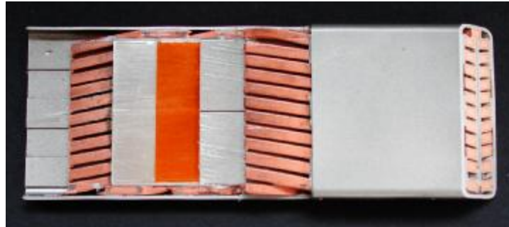
Bild F2: Darstellung der einzelnen Lagen des Leiters der EU-LCT-Spule
