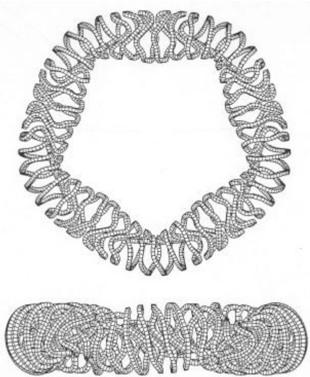
Bild 9: Spulensystem des Stellarators Wendelstein 7-X in Drauf- und Seitenansicht [13]
