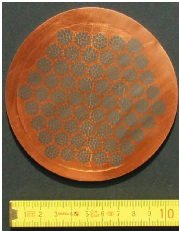
Bild F1: Schnittbild der Kupfermatrix mit integriertem Supraleiter
