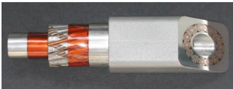
Bild F3: Leiter der POLO-Spule. Links in schichtweiser Darstellung, Rechts die Detailansicht der Schnittfläche mit einzelnen Strands
