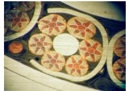
Bild F3: Leiter der POLO-Spule. Links in schichtweiser Darstellung, Rechts die Detailansicht der Schnittfläche mit einzelnen Strands
