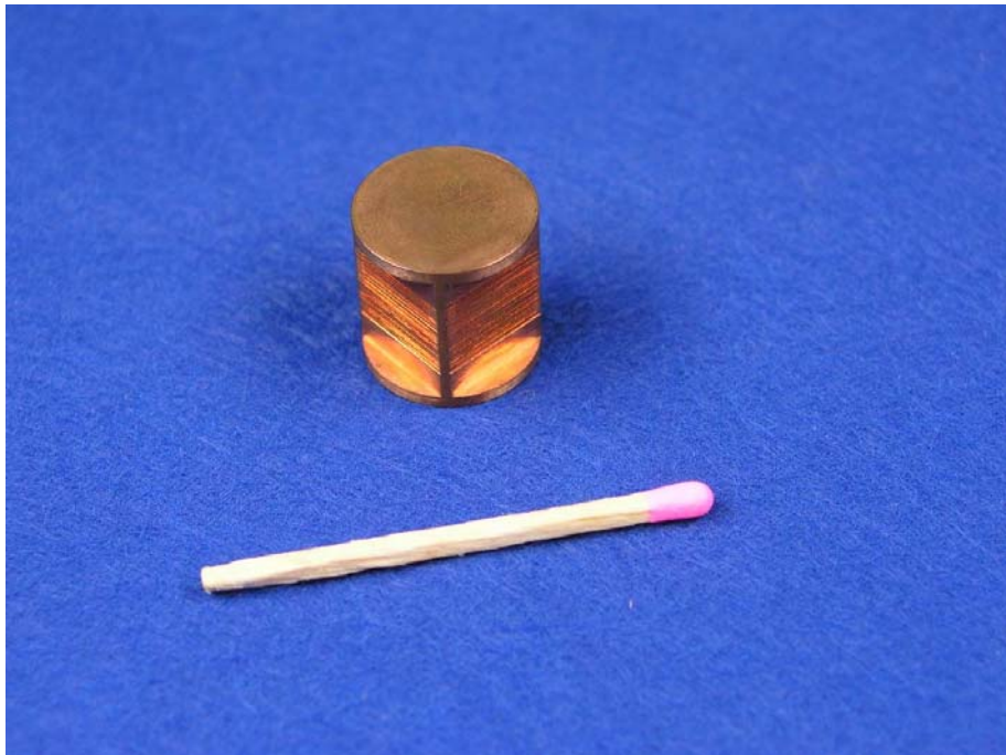
Abbildung 2: Mikrowärmetauscher aus Kupfer; entwickelt und gefertigt am Forschungszentrum Karlsruhe.
