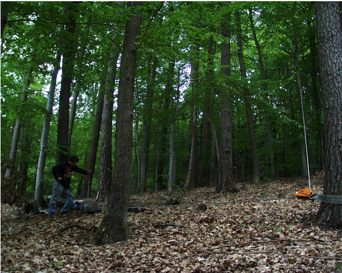
Abbildung 3.3.: Der Versuchsaufbau beim Umziehversuch: Die Kraft wird mittels eines Greifzuges auf das Stahlseil aufgegeben. Die Umlenkung erfolgt aus Sicherheitsgründen. Die Kraftmessdose ist am Greifzug angebracht.
