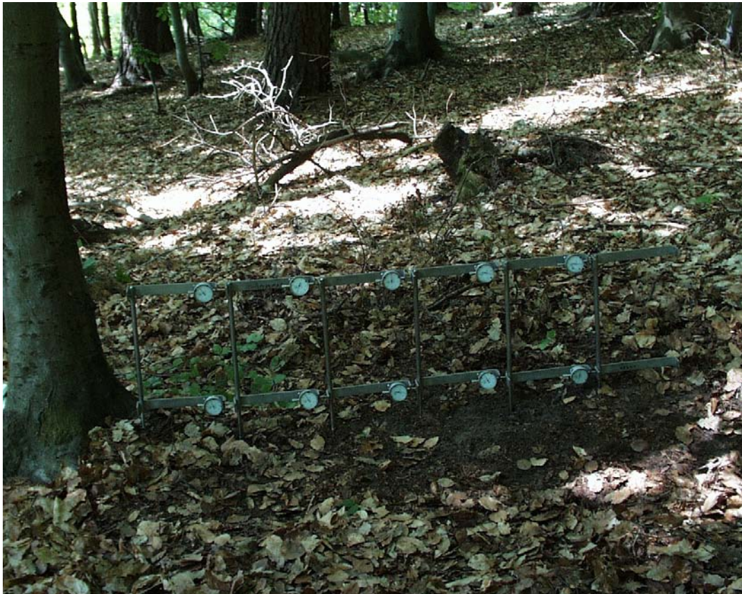
Abbildung 3.8.: Die Anordnung der Messuhren im zugbelasteten Wurzelplattenbereich.
