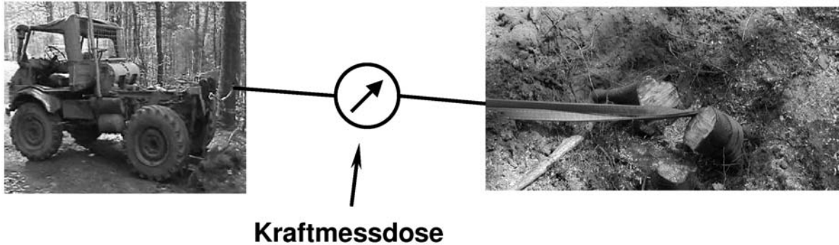
Abbildung 3.5.: Die Versuchsanordnung des Ausreissversuchs im Forst: Die Motorwinde kann eine maximale Nennlast von 60kN aufbringen, was die Wahl der Baumgröße auf Exemplare mit Stammdurchmessern kleiner 15cm beschränkt.
