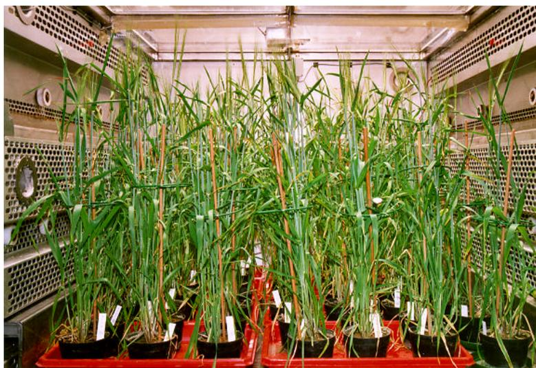
**Abb. 2.3:** Expositions-kammer zur Simulation von Globalstrahlung an der GSF, Neuherberg mit Gerstenpflanzen im Entwicklungsstadium BBCH 55 (Foto: J.P. Schnitzler, IMK-IFU).
