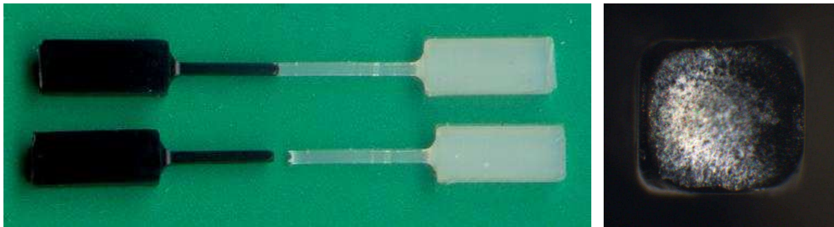
Bild 4.4: Links: 2K-Zugstäbe aus PA12-C und ungefülltem PA12, rechts: Aufsicht auf die Bruchfläche des PA12-C
