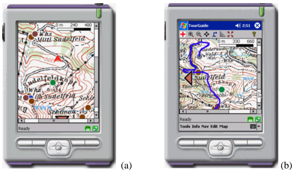
Abb. 10. Topographische Karte mit POIs und angezeichneter Position des Nutzers (a), und Routenberechnung (b) im PARAMOUNT Projekt.
