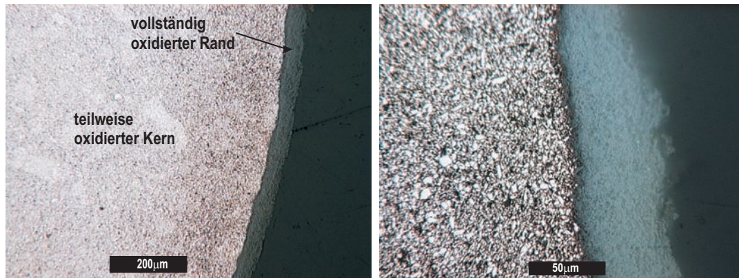
Abbildung 4.25: Lichtmikroskopische Aufnahme eines Querschnittes eines teiloxydierten \text{ZrAl}_3 -Grünkörpers ( \varnothing = 5,9 \text{ mm} , \sim 5 \text{ mm} lang, \rho_{\text{grün}} \approx 65 \% \text{ TD} ; Heizrate 20 \text{ }^\circ\text{C}/\text{min} in einem Kammerofen).
