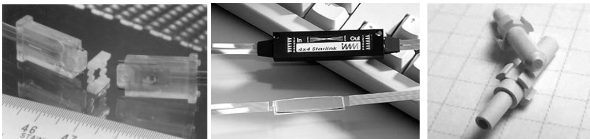
Abb. 2.4-1 Von links nach rechts: Konfektionierter Multifasersteckverbinder mit Zwischenstück, mikrooptischer 4x4 Verzweiger (IMM Mainz) und Faserstecker aus LCP (Rolla Microsynthetics).
