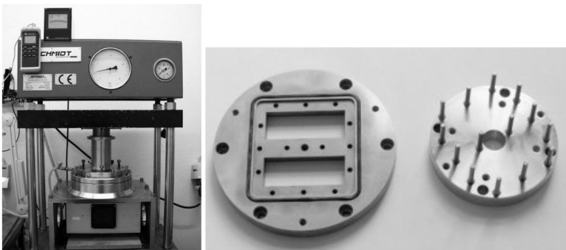
Abb. 2.2.3-3 Versuchsstand Photomolding: Gesamtansicht und Formeinsatzhalteplatte mit Auswerferkranz.
