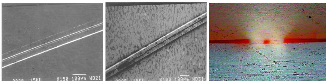
Abb. 2.5.3-1 Messingformeinsatz, abgeformtes Bauteil sowie gefüllter und gedeckelter Monomodewellenleiter aus PMMA, wellenleitendes Material ist PMMA, dotiert mit dem Farbstoff Disperse Red 1.
