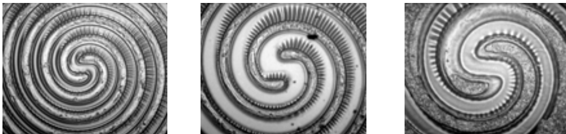
Abb. 6.6-2 UV-lithographisch im contact mode erzeugte Strukturen in reinem Ceraset unter Verwendung der in Abb. 6.4-1 gezeigten Maske. Belichtungsleistung 60%, Belichtungszeit 5 min, Entwickler: Aceton, Entwicklungszeit 1.5 min.
