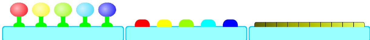
**Abb. 2.5:** Schematische Darstellung unterschiedlicher Gassensor-Arrays (links klassische Makrobauweise, mitte GSMA mit separaten Schichtsensoren, rechts GSMA als segmentierter Metalloxidfilm).
