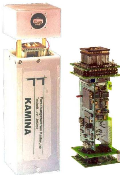
**Abb. 3.8:** Foto der KAMINA mit eingebautem GSMA (links) und der freigelegten Elektronik (rechts)
