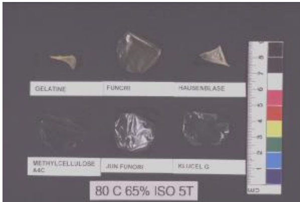
Klebstofffilme nach der beschleunigten Alterung nach ISO 5630 bei 80°C, 65 % Relativer Feuchte für 5 Tage.
