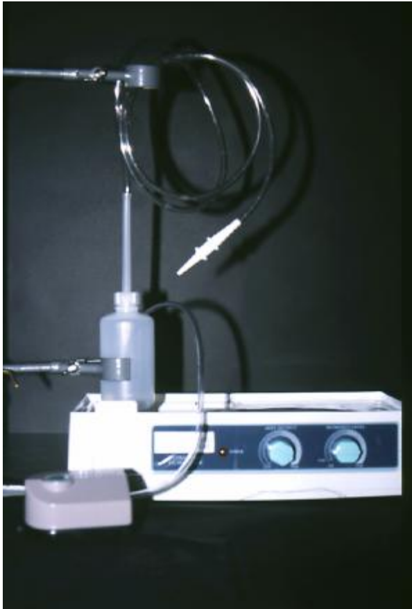
CCI-Mister mit Ultraschallbefeuchter, LDPE-(Low density Polyethylen) Flasche und Aquariumpumpe.
