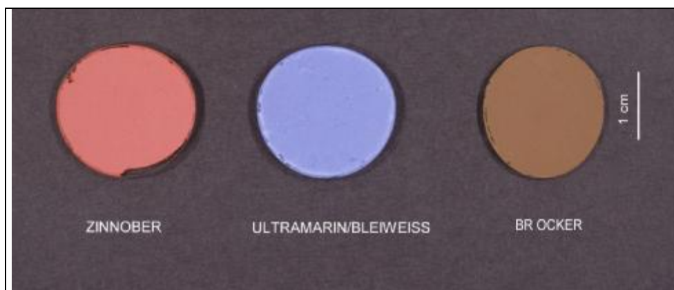
Abb. 26: Zinnober, Mischung Ultramarin/Bleiweiß und brauner Ocker auf Glas-bzw. Plexiglasträger mit dem Spincoat-Verfahren hergestellt.
