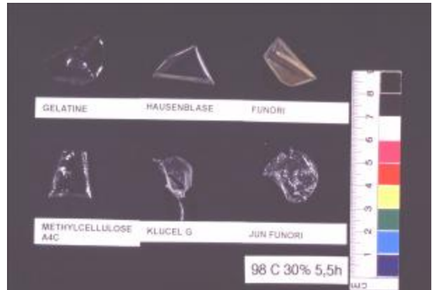
Klebstofffilme nach der beschleunigten Alterung bei 98°C, 30 % Relativer Feuchte für 5,5 Tage.
