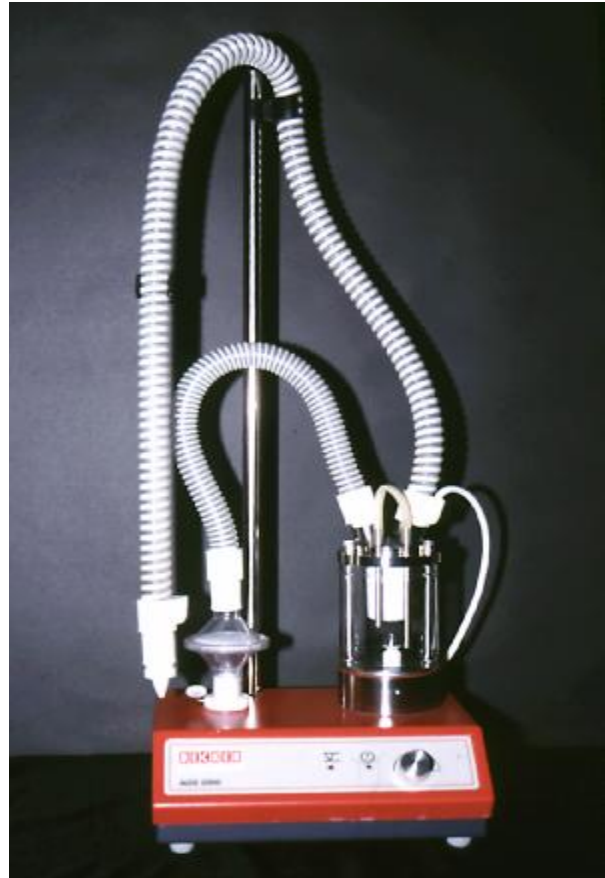
AGS 2000, Wasserreservoir mit Klebstoffbecher (rechts), Schlauch von der Luftpumpe und Schlauch zum Transport des Nebels mit Düse.
