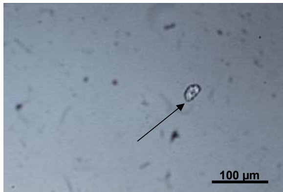
Abb. 48: Gelatine-Klebstofffilm, klar mit kleinen Verklumpungen, nach Abnahme von der Polystyrol-Petrischale.
