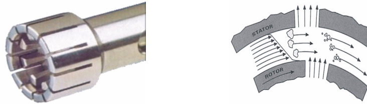
Abb. 4-6: Links: UltraTurrax Rührerkopf; rechts: Strömungsprofil im UltraTurrax.
