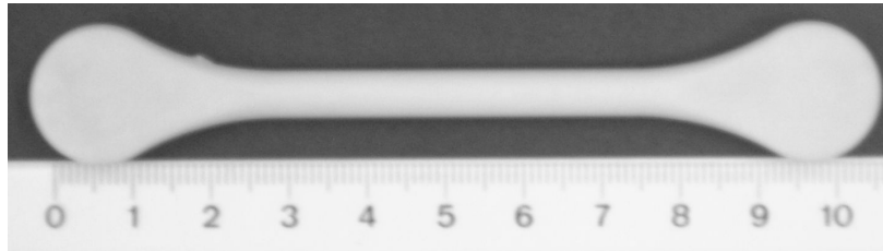
Abb. 4-15: Zugprobe aus PMMA-Nanokompositmaterial.
