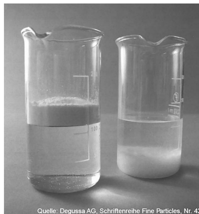
Abb. 4-5: Hydrophobes (links) bzw. hydrophiles Keramikpulver in Wasser.
