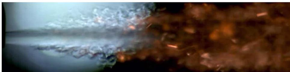
Abbildung 5.3: Verbrennung von DME im zweiphasigen Freistrah durch Expansion von  $87\text{ bar}$ ,  $360\text{ K}$  auf Kammerbedingungen von  $35\text{ bar}$ ,  $723\text{ K}$  Luft (vgl. Abb. 2.2). Der flüssige und teilverdampfte Strahl ist in der Schattenaufnahme deutlicher sichtbar, im Rußleuchten ist Tropfenabbrand zu erkennen.
