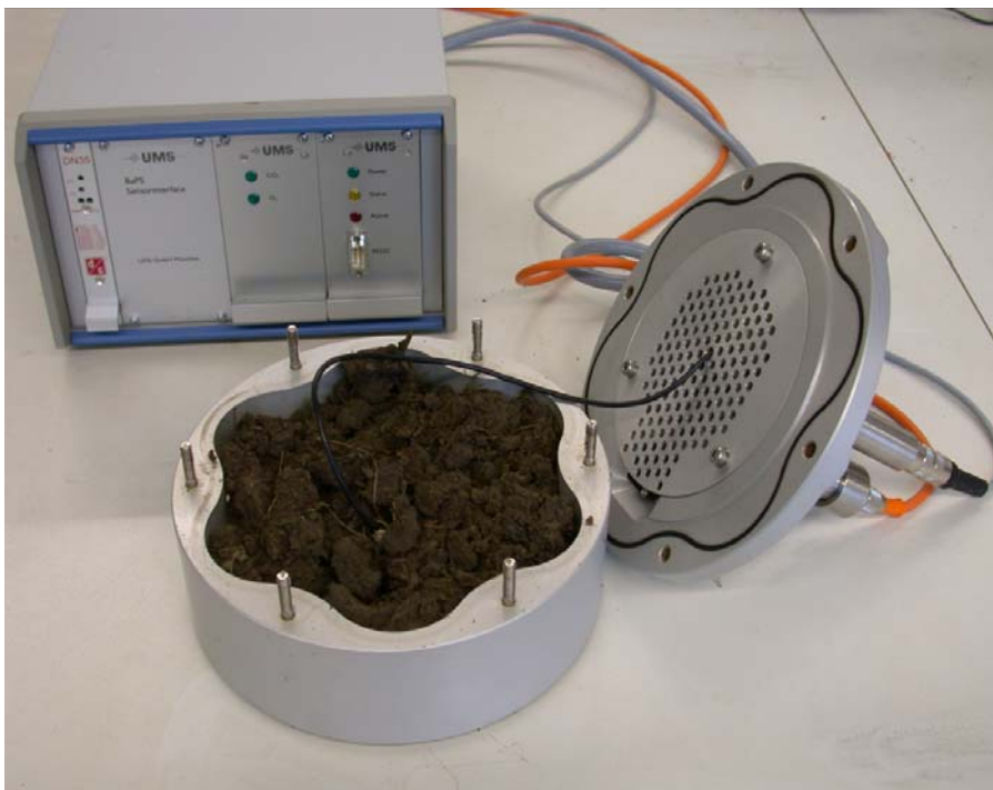
Abb. 4: Das BaPS-Messsystem mit Sensorinterface (linker Hintergrund), Messküvette mit Boden und Sensorkopf (rechts im Bild).
