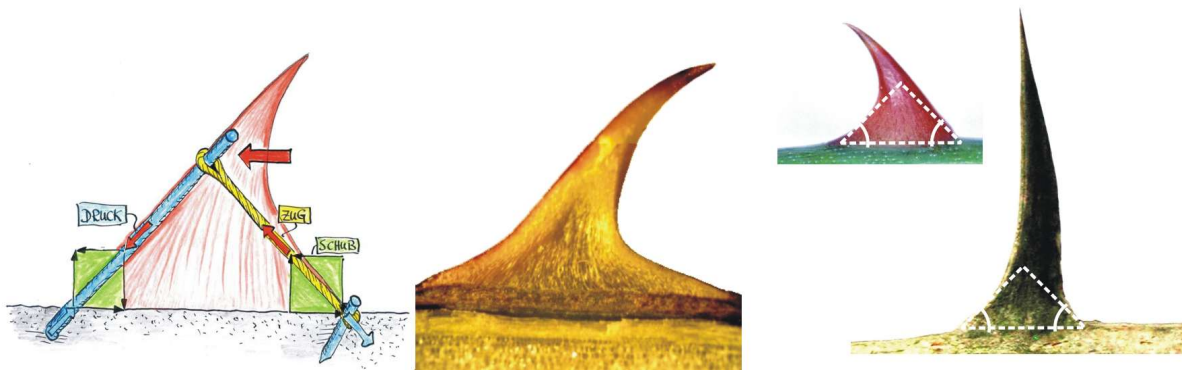
Abbildung 5.4: Links: Mechanisches Ersatzmodell eines Rosenstachels (Zeichnung C. Mattheck); mitte: Längsschnitt durch einen Rosenstachel (Foto K. Weber); rechts: 45°-Winkel an der Anbindung von Dornen und Stacheln.
