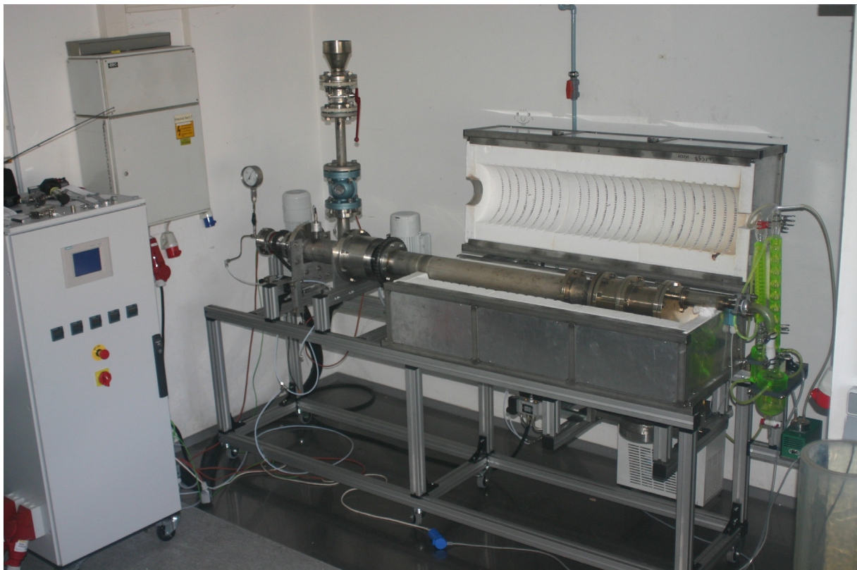
Abbildung 4.2: Labordrehrohr mit innen beheizter Schnecke für die Pyrolyse von Elektronikschrott.
