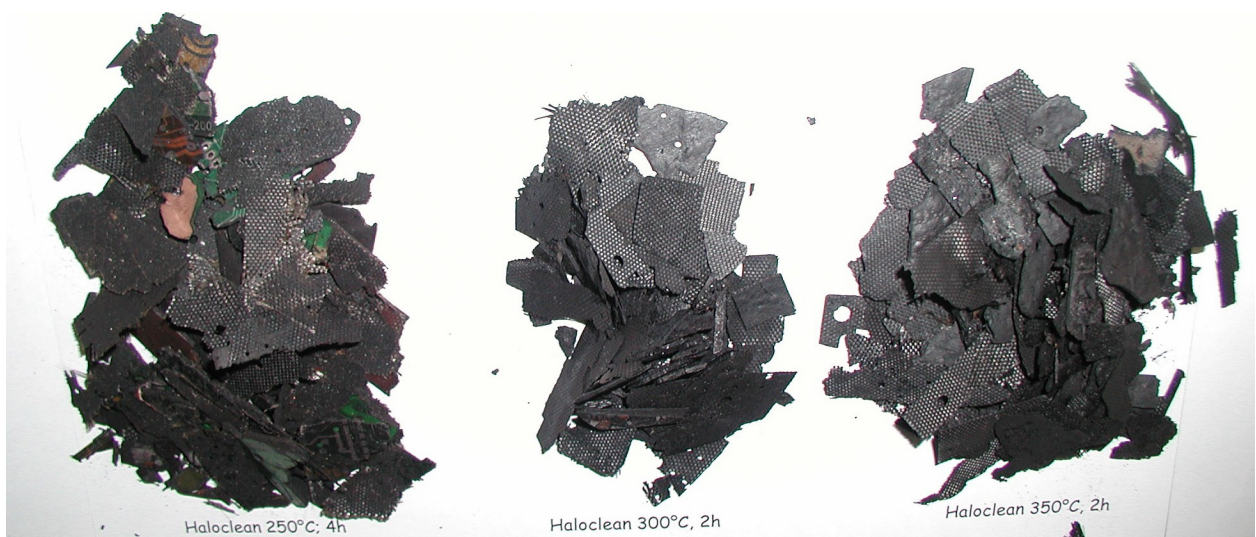
Abbildung 5.5: Bei verschiedenen Temperaturen pyrolysiertes Elektronikschrott aus Leiterplatten nach der ersten Pyrolysestufe (Versuche DI1 bis DI3).
