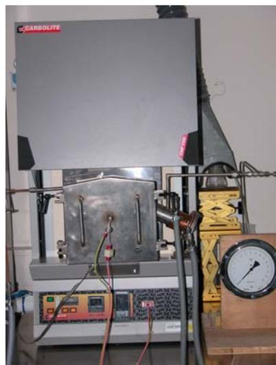
Abbildung 4.11 Zur thermischen Entbinderung herangezogener Kammerofen der Firma Carbolite mit gasdurchströmbarer Einsatz.
