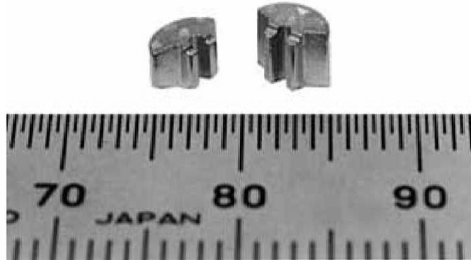
Abbildung 3.12 Von Seiko-Epson im MIM-Prozess für einen Einsatz in Mobiltelefonen gefertigte WHA-Bauteile [BOS 03].
