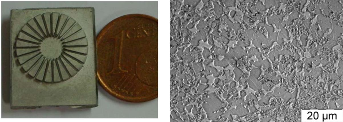
Abbildung 5.68 Bei 1450°C gesintertes Slot Array 24 aus WHA (W-Ni-Fe =92,5:5:2,5) (links) sowie das Sintergefüge der Probe (rechts).
