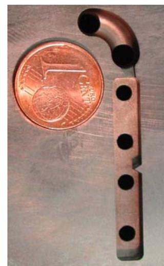
Abbildung 4.8 Technische Zeichnung mit Angaben in mm (links) und photographische Abbildung (rechts) der Kavität zur Abformung von Kerbschlagbiegeproben.
