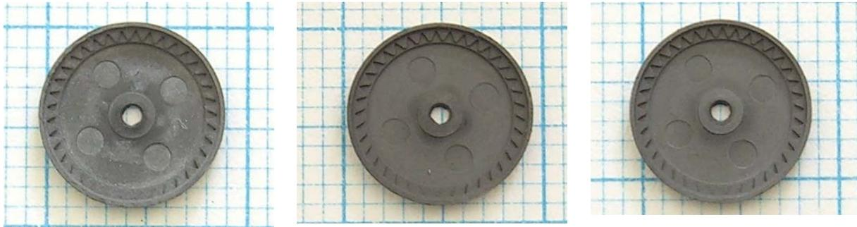
Abbildung 5.51 Aus den in Tabelle 5.18 genannten Formmassen gefertigte Getriebegehäuse: W (links), W + 1 Gew.%  $\text{La}_2\text{O}_3$  (Mitte), W-Ni-Fe (rechts) [ZEE 06].
