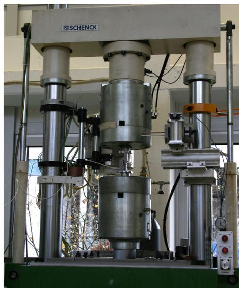
**Abbildung 5.1:** Servohydraulische Torsionsprüfmaschine der Firma Schenck
