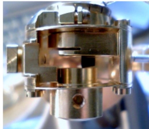
Abbildung 2.4: Links : Schematischer Plan des Dilatometers. Beschreibung siehe Text. Rechts : Dilatometer mit eingebauter Probe.
