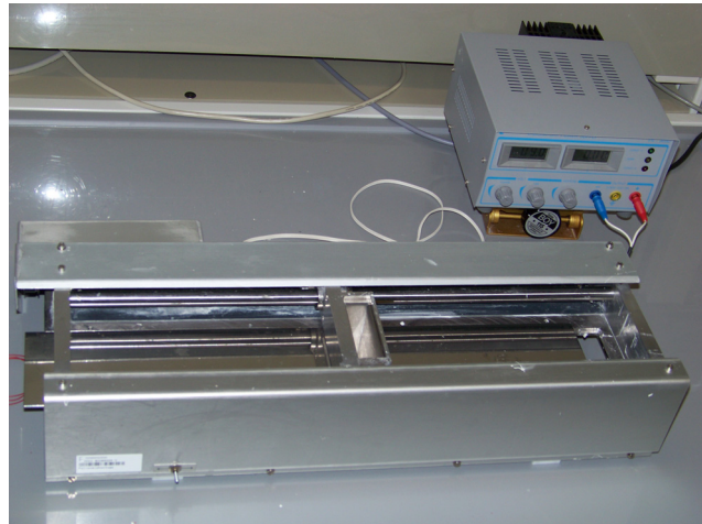
Abbildung 3.3: Verwendete Tape Casting Maschine für den Schablonendruck
