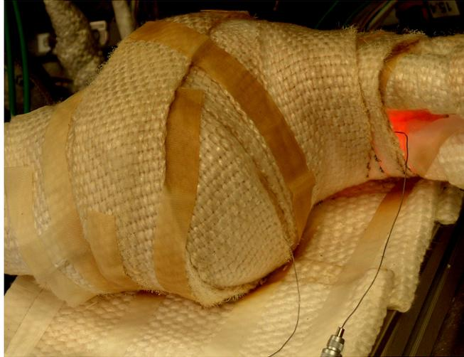
Abbildung 67: Aufnahme des Systemreaktors im Betrieb bei 800°C
