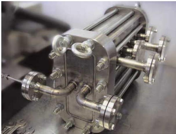
Abbildung 14: Produktionsreaktor in der chemischen Industrie mit mehreren 10.000 Mikrokanälen [74]
