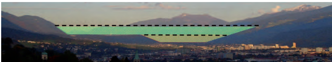
Abbildung 1.1: Vergleich von Querschnittsflächen in Abhängigkeit der Inversionshöhe im Inntal in der Höhe Wattens mit Plateau Gnadental. Bei geringerer Querschnittsfläche verringert sich auch das Luftvolumen unterhalb der Inversion drastisch.
