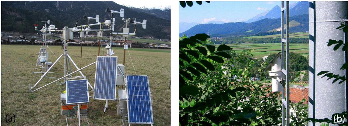
**Abbildung 3.6:** Messaufbau während der Vergleichsmessungen im März 2008 am Standort Schwaz in der Talmitte (a). Die Station an der linken Bildseite befand sich am Vomperberg, die zweite Station von links ist die automatische Wetterstation des Standortes Schwaz. Im rechten Abbildungsteil (b) ist ein Hobo-Temperatursensor (KJ03) des Temperaturprofils Kellerjoch abgebildet.
