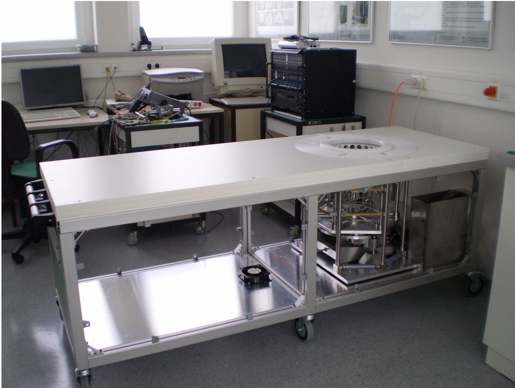
Abbildung 1.5: USCT3Dv2 Gesamtaufbau: (Mitte) zerlegter Messaufbau, (rechts in der Liege) eingebaut der Messbehälter mit leeren Sockeln für Sensoren, darunter Hub- und Rotationsmechanik, (links-oben) Kontroll-PC, (rechts-mitte) DAQ Hardware
