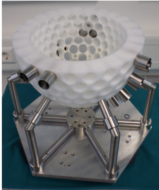
Abbildung 1.4: Der Messbehälter des 3D USCT II mit einzelnen eingesteckten Sensorhüllen. Die neue ellipsoide Form verspricht eine bessere Ausleuchtung des Messbehälterinhaltes durch die Sendesignale. Der 3D USCT II ist für die ersten klinischen Studien vorgesehen.
