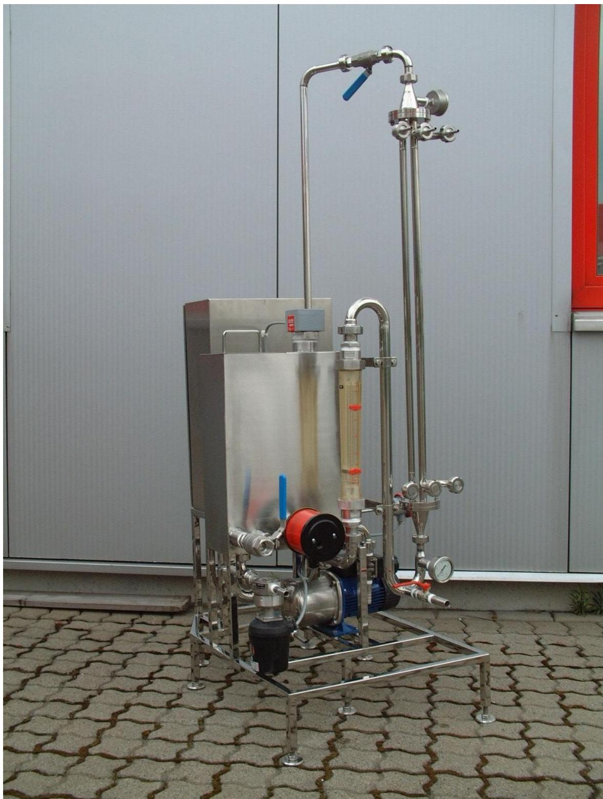
Abbildung 9-10: Testsäulen für die Langsandsandfiltration am IWG
